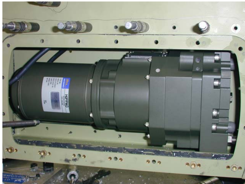
Photo 13 : Intégration d'un compresseur HiPPAG dans le Tri-Bombe Rafale
