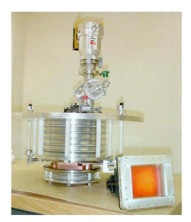
Figure 4.2: 9 GHz Super Reltron.
